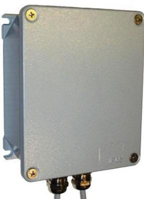
Представляет из себя репитер **Commeng RPT 100B-TX f/f** с платой защиты **Commeng RPT-PM**, установленный в алюминиевый корпус. Монтаж производится на поверхность. Установочный размер: 100x120 мм, 4 отверстия по углам прямоугольника d=5,2 мм.
