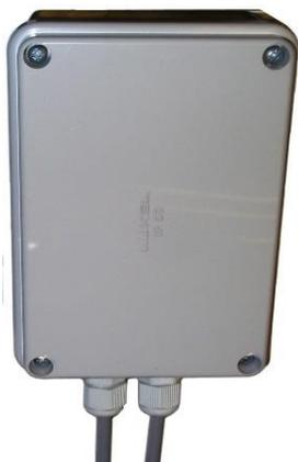
Представляет из себя репитер **Commeng RPT 100B-TX f/f** установленный в пластиковый корпус. Монтаж производится на поверхность. В том случае, если предполагается эксплуатация в условиях возможного воздействия перенапряжений (линия проходит вне зданий или в непосредственной близости от источников возможных помех) необходимо дополнительно установить плату грозозащиты **Commeng RPT-PM**.
